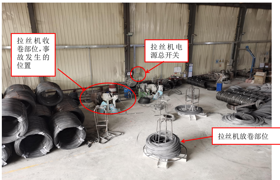
图一 事故现场情况
